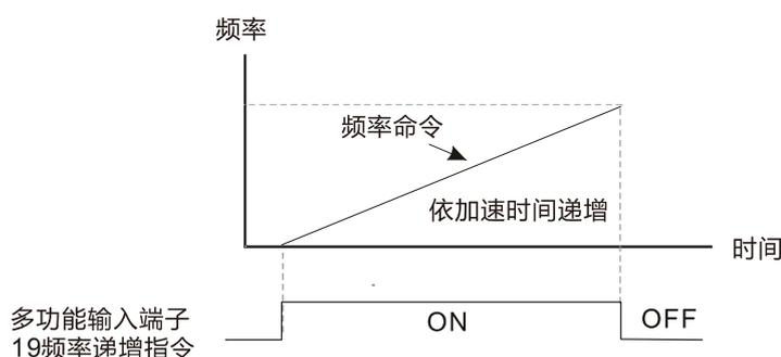
参数 02-09 设定值为 1 时, 依据参数 02-10 之设定值 0.001~1.000 Hz/ms 来递增 / 递减频率命令 (F)。
