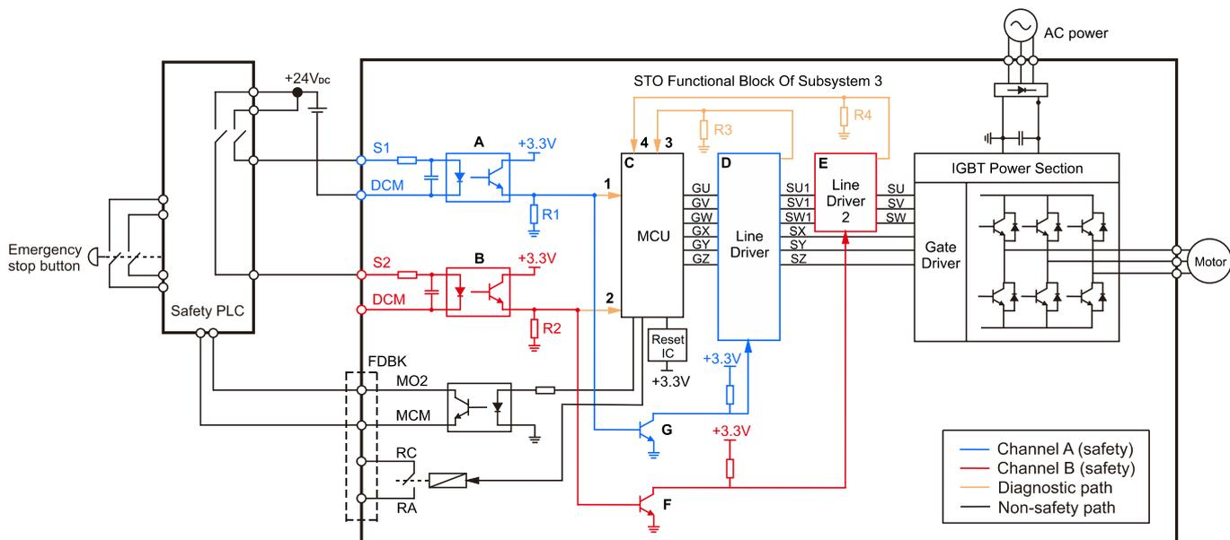
图 17-1、安全转矩停止功能之电路方块图
