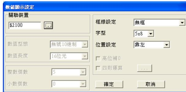
**关联装置**可以选择想要读取的 VFD 通讯位置，如想读取输出频率 (H)，设定\$2202。(其余数值请参照第 12 章第 09 参数群参数 09-04 的 ACMD ModBus Comm Address List 文件)。
