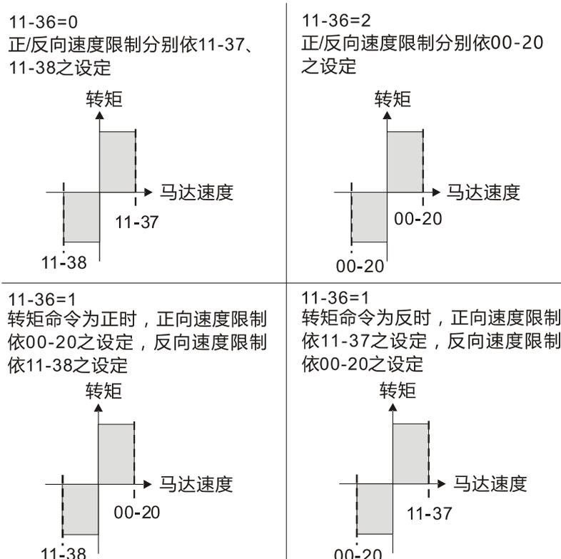
**11-37 转矩控制正方向速度限制**
