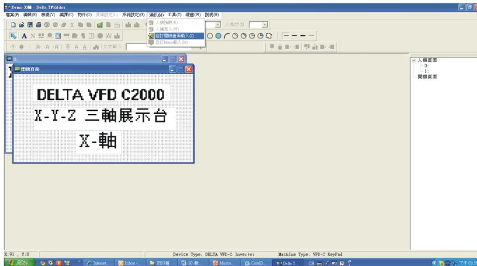
9. 下载设定，至**工具**→**通讯协议**设定 IFD6530 的通讯端口与速度，速度只支持 9600、19200、38400 三种。
