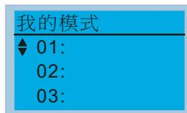
客户可在参数设定值页面中，按下 F4 键，就会储存到我的模式中，而在我的模式中，可进去修改参数设定值，若想删除参数项目，须进入此参数后，画面的右下角出现 DEL 字样时，即可清除此参数。
