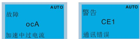
1. 按 ENTER 键做 RESET 动作，若无任何反应，请洽询各地代理商或送厂维修以了解其故障原因。若想查阅当时异常的 DC bus 电压值，输出电流/电压值，可以按 MENU 键选择“故障纪录”来查阅详细的状况。（请参考上述“6 故障纪录”内容说明）。
