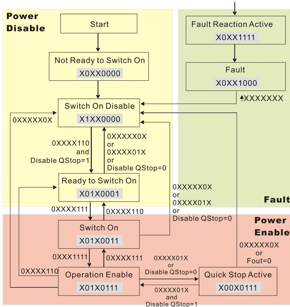
一般而言，可以直接下 6040 = 0xE，再下 6040 = 0xF，应该就可以切换到 Operation Enable 的状态了。而控制状态从 Quick Stop Active 返回 Operation Enable 的方向线是由 Index 605A 的选择决定。当设定值为 1~3 时，此方向线有效，反之 605A 设为其他值时，当变频器状态切换到 Quick Stop Active 时，则无法直接再返回 Operation Enable。
