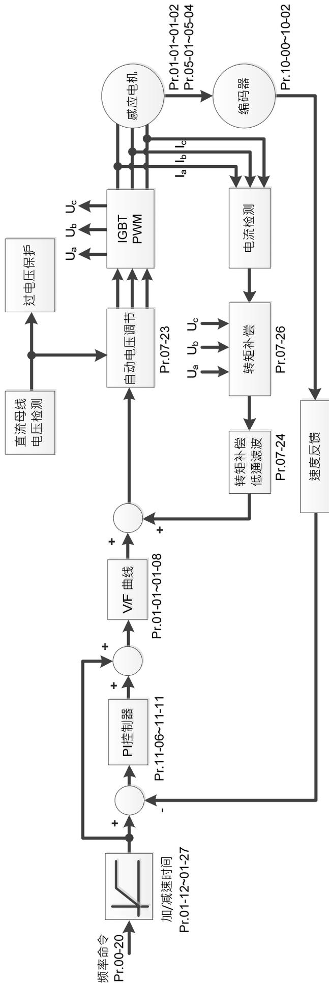
参数 00-10 = 0 且 00-11 设定值为 2，无感测向量控制方块图如下：
