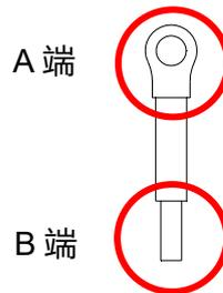
图 8-20 接地线
