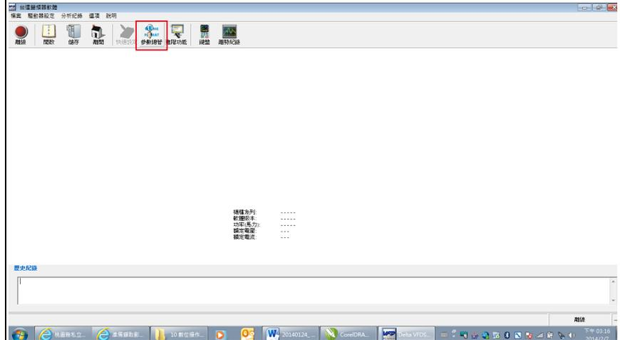
进入参数总管后，选择**表格功能**中的**从 KPC-CC01 加载参数表**
