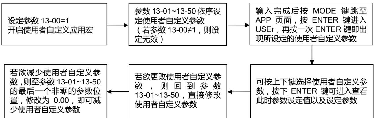
1. 使用者可至参数 13-01~13-50 根据需求照顺序设定自定义参数，默认值为 0-00 即代表目前无自定义参数。按下 ENTER 键后可将对应数设定至参数 13-01~13-50 中。
