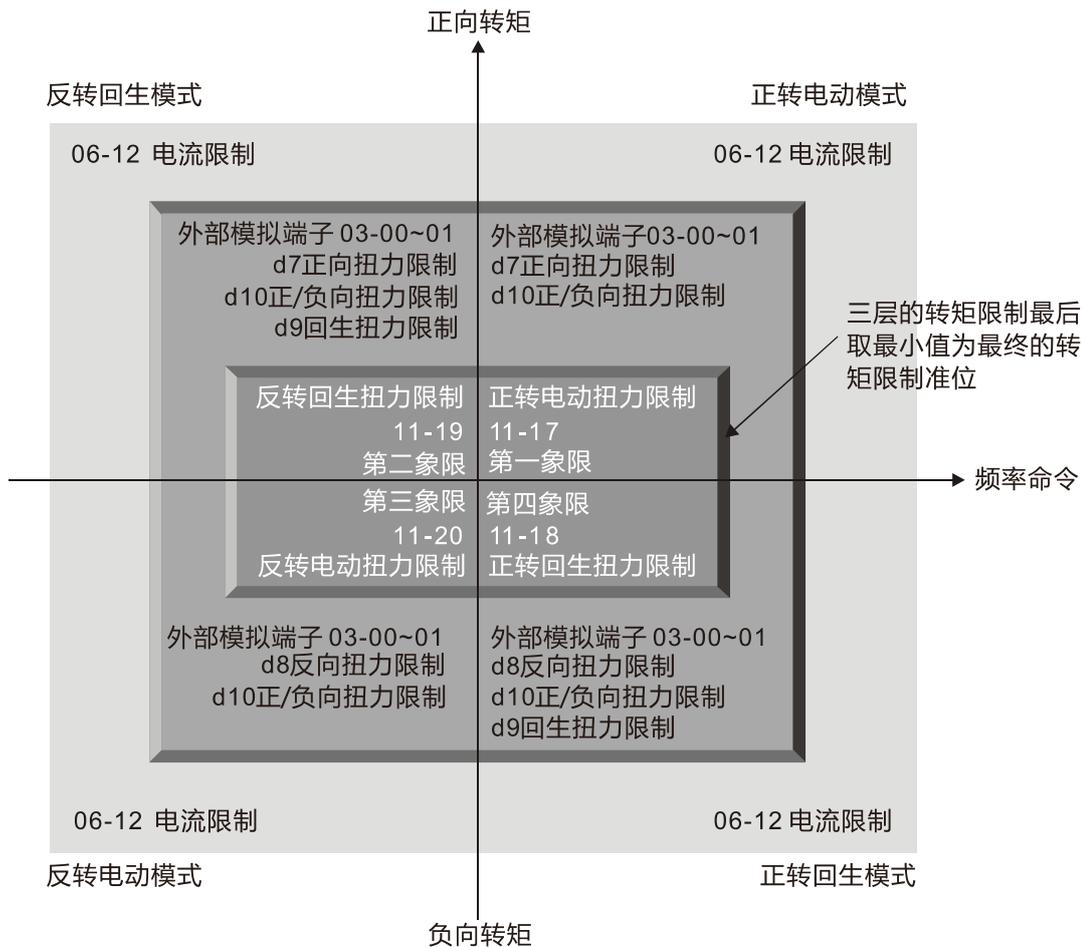
📖 除了 IM : VF、VFPG、SVC 与 PM : PMSVC 等四种模式以外的控制模式以电机额定电流为百分比基值。
