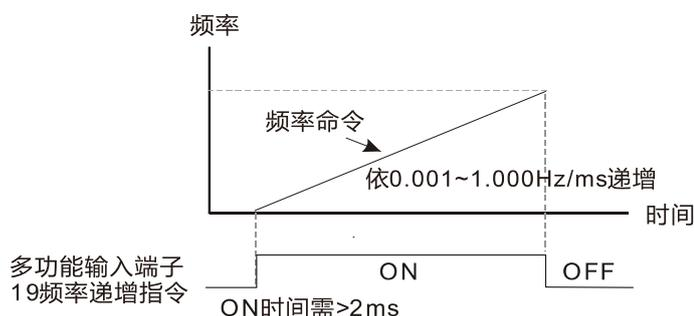
☞ 参数 02-09 设定值为 4 时,依据参数 02-10 之设定值 0.001~1.000 Hz/100ms 来步阶递增 / 递减频率命令 (F)。
