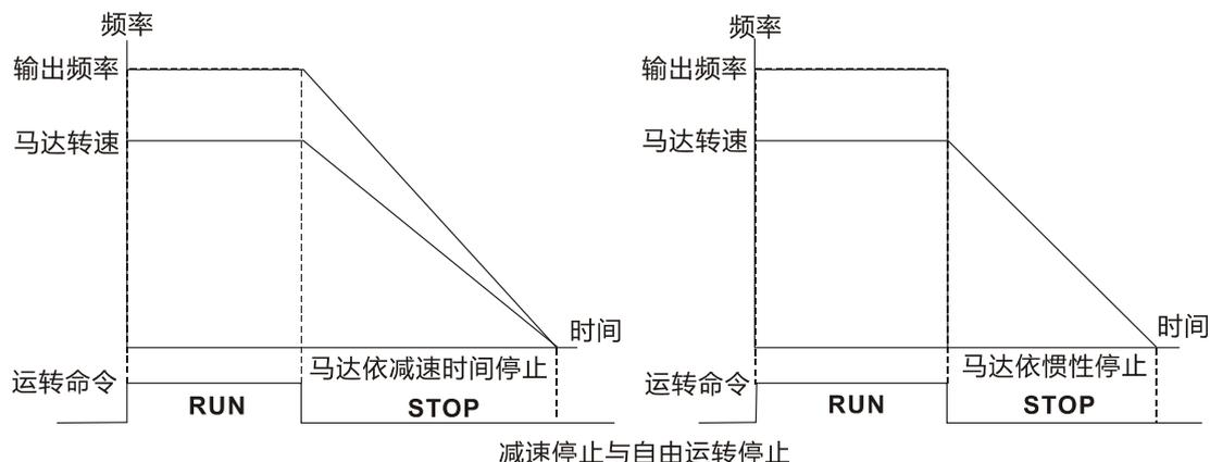
1. 电机以减速煞车方式停止：变频器会依目前所设定的减速时间，减速至 0 Hz 或〔最低输出频率〕（参数 01-07）后停止。
