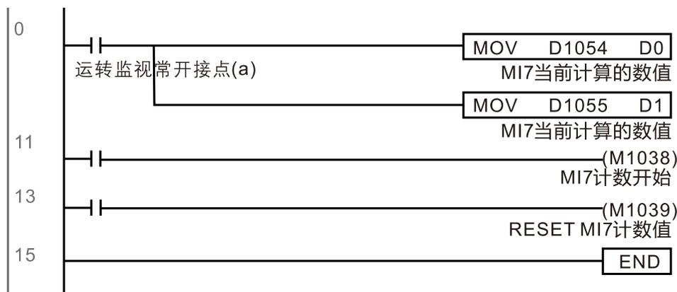
※ 当 PLC 程序里有定义到 MI7 当作高速计数器使用时，也就是 PLC 程序里，有编写到 M1038 或 M1039 时，则 MI7 的原功能无效。
