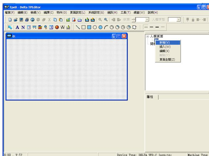
2. 点击软件画面右侧**人机页面**底下想要编辑的页码，或**检视→人机页面**，开始编辑主画面。可使用的对象如图所示：由左至右依序为静态文字、数值显示、静态图形、刻度、条状图、按钮、万年历、灯号显示、度量衡、输入值，以及 11 个几何图形与几何图形线条粗细。其中静态文字、静态图形与几何图形的使用方法与前述编辑开机画面的方法相同。
