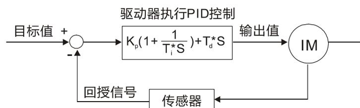
$K_p$  比例增益（P 控制）， $T_i$  积分时间（I 控制）， $T_d$  微分时间（D 控制），S 演算
