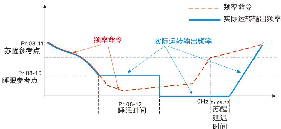
2) 内部 PID 计算频率命令 (使用 PID, 参数 08-00 ≠ 0 且 08-18 = 0)
