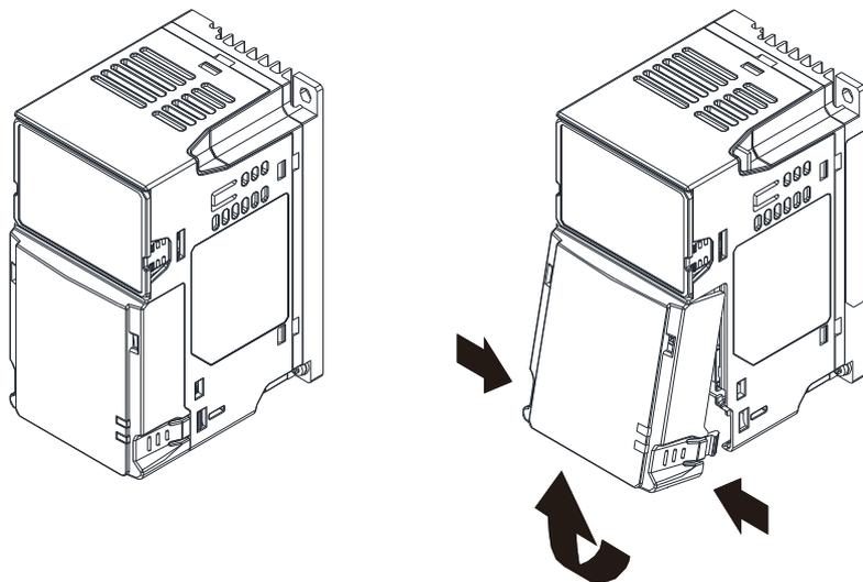
按压两侧卡勾，将前盖旋转开启
