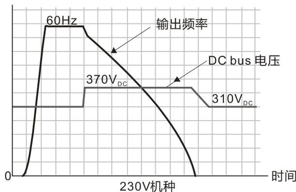
📖 过电压失速防止动作时，变频器的减速时间将大于所设定的时间。
