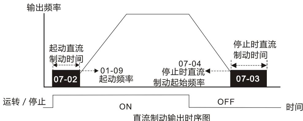
☞ 运转前的直流煞车通常应用于如风车、帮浦等停止时负载可移动之场合。这些负载在变频器启动前电机通常处于自由运转中，且运转方向不定，可于启动前先执行直流制动再启动电机。
