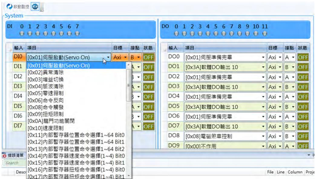
系統 I/O 支援 DI 軟體控制，執行 DO 軟體控制時需再將訊號的功能項目設定為軟體 DO 輸出方能正常使用，如下圖所示。
