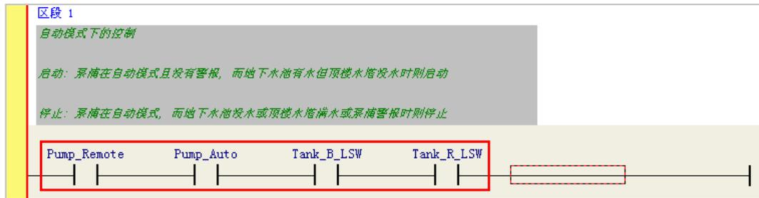
这时要地下水池有水而顶楼水塔没水的条件，所以 Tank\_R\_LSW 的状态必须为 False 才正确，这时可以使用鼠标连点两下 Tank\_R\_LSW 的接点图标，系统会显示接点选择的下拉选单，从里面选择我们需要的常闭接点型式。
