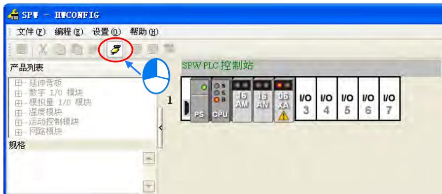
一般来说，主机的BUS FAULT灯号亮起都是指硬件架构有错误，所以我们可以选择一下目前有错误的06XA模块，然后利用右键的选单方式选择「诊断」。
